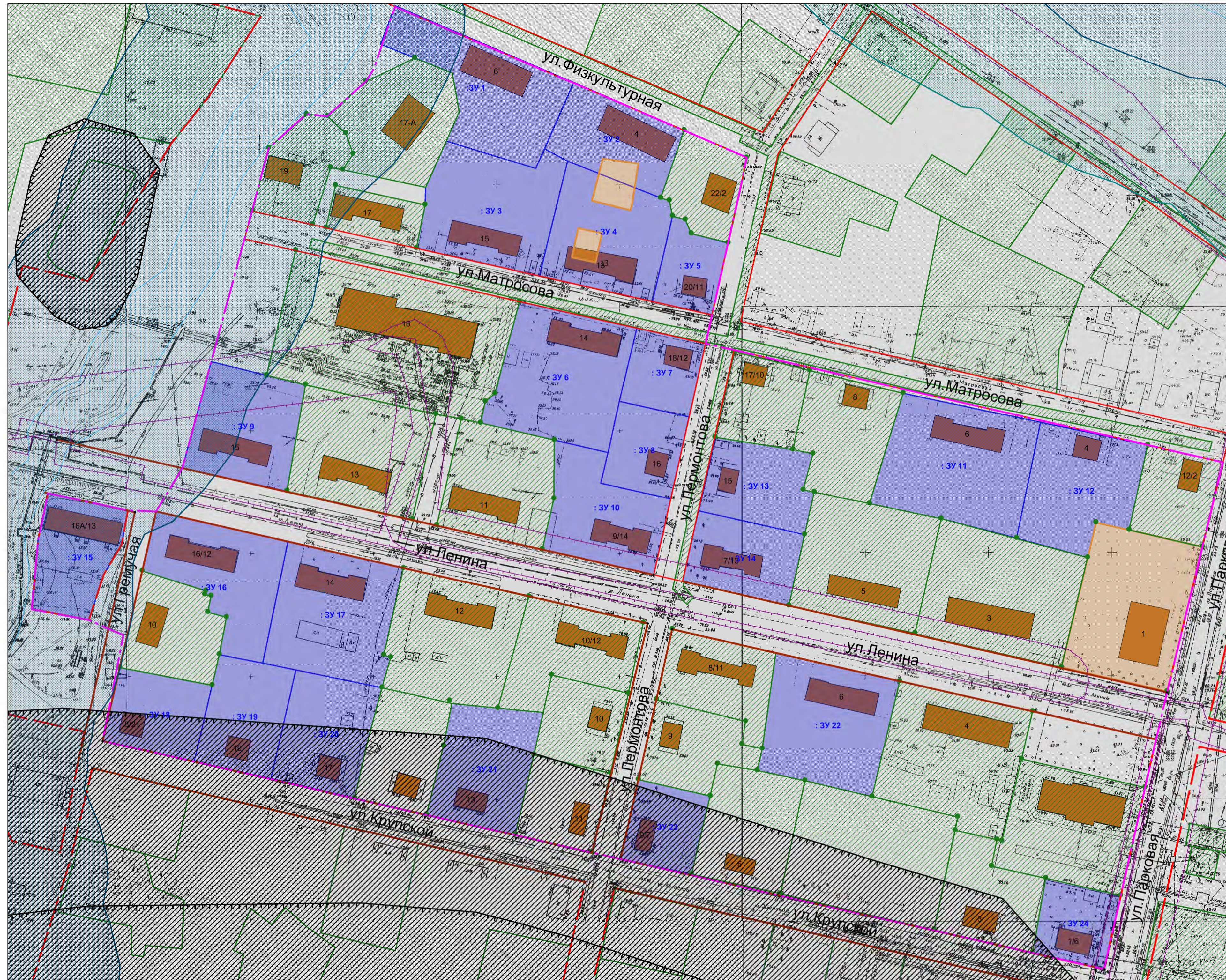
2.1 Чертеж межевания территории с указанием границ зон с особыми условиями использования территории Масштаб 1:1000
